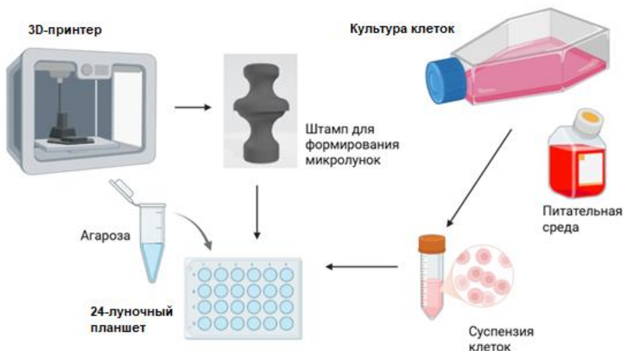
Рис. 1. Общая схема получения сфероидов с помощью штампов, изготовленных на 3D-принтере
